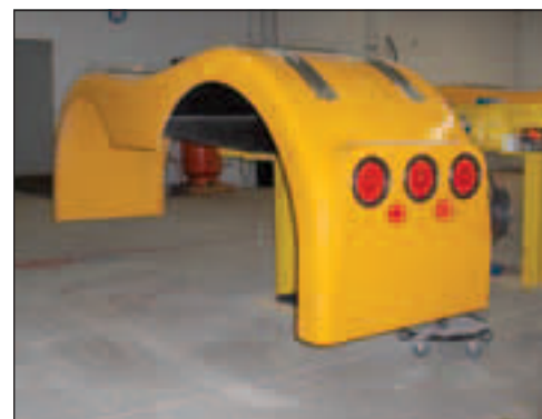
Faite de fibre de verre, l'aile Méka résiste évidemment à la corrosion et est disponible en nombreux coloris.
