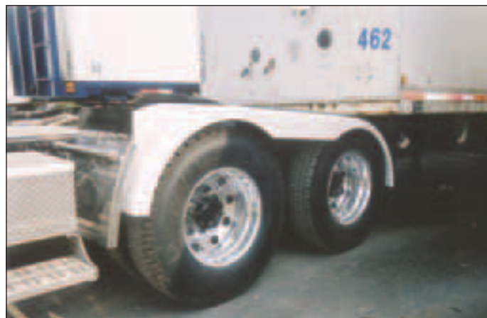
L'aile se soulève, s'abaisse et bascule sous le poids de la remorque sans abaisser la suspension du camion. Afin de permettre l'effet balancier, elle est installée au centre des roues du tandem sans soudure, perçage ou modification au camion.
